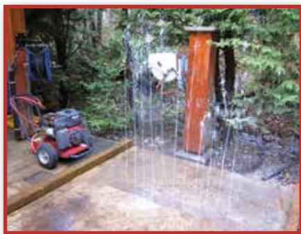
A 4×4-es rekeszekben van a vágott fű, a nagynyomású vizes mosó le tudja takarítani a fűnyíró teljes alját. A vízoszlop teljes nyomáson 7 méter magas. A gyerekek is szeretnek vele játszani
