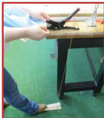
A fejed használd, ne a pénztárcád! Ez az egyszerű fejlesztés, egy házi készítésű fapedálhoz csatlakoztatott madzag és egy fogó, mely krimpelő eszközként működik, így az operátor keze szabad, fejét pedig a következő nagyszerű fejlesztésen törheti
